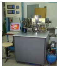
Действующий лабораторный прототип MO CVD реактор
